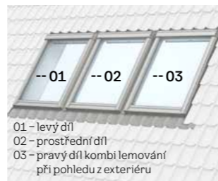
Trojice střešních oken vedle sebe s krokve
