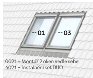
Dvojice oken vedle sebe s krokví / Dvojice oken vedle sebe s instalačním setem DUO
